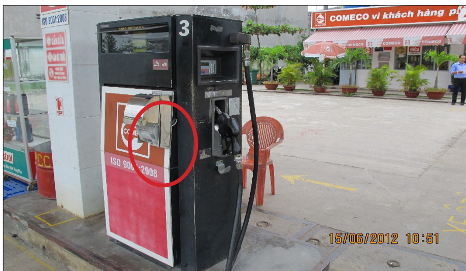
Cột đo xăng dầu được gắn máy in chứng từ cung cấp cho khách hàng
